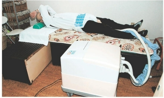
センサー付きカップをおむつの要領で装着し、排せつ物を自動吸引する「スマイレット安寝」
